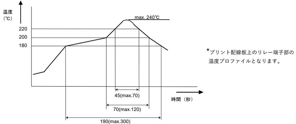
2. リフロープロファイル (JEDEC規格対応条件) \* 250°Cリフロー対応品名専用 (L8仕様)
