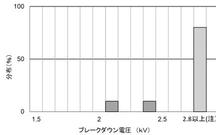
(注) 2.8 kV以上印加すると、リレー外部（端子間）で短絡する場合があります。
